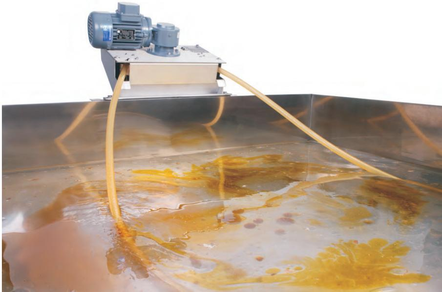
**Einfach, schnell und zuverlässig entfernt der Friess Ölskimmer Modell W40 aufschwimmende Öle von Emulsion, Waschwasser oder Abwasser.**
